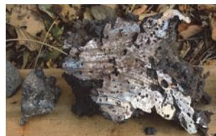
たたら製鉄で生成されたケラ
