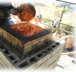
上：砂鉄を炉に入れます。左：でき上がった鉄の塊
